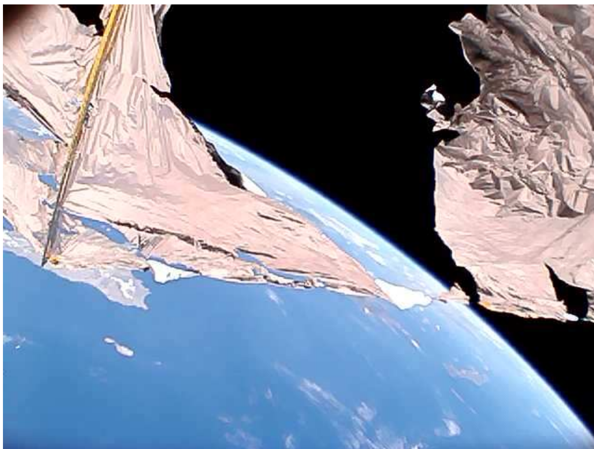
Fot. 3 – Fragment uszkodzonego materiału żagla (źródło: https://pw-sat.pl/pw-sat/ )
